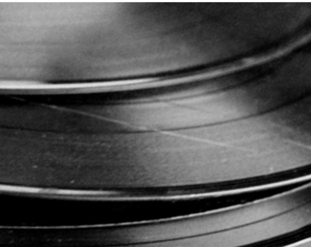
Technik. Eine einzige spiralförmige Rille genügt um die Schallschwingungen abzubilden und zur Wiedergabe benötigt man lediglich die Abtastnadel eines Tonabnehmers, der diese mechanisch bzw. elektromechanisch in hörbare Schallwellen zurückverwandelt.
