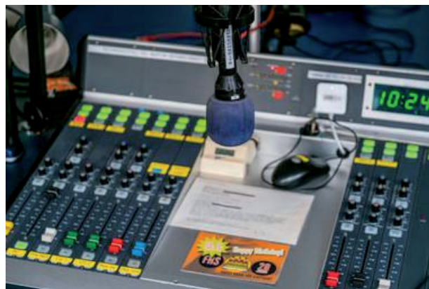
Popschutz muss sein: Das blaue Ding überm Mikro macht Plosivlaute wie "t" und "p" weich.
